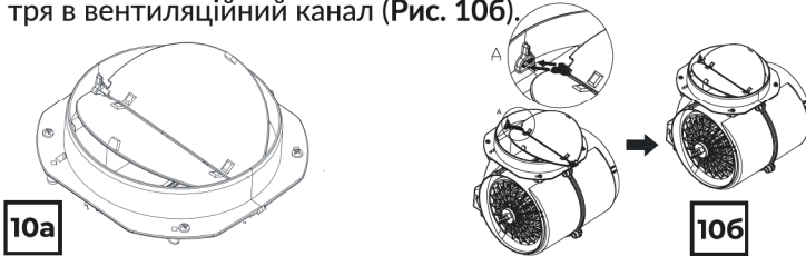
Рис. 10. а) загальний вид зворотного клапану; б) встановлення зворотного клапану на двигун
